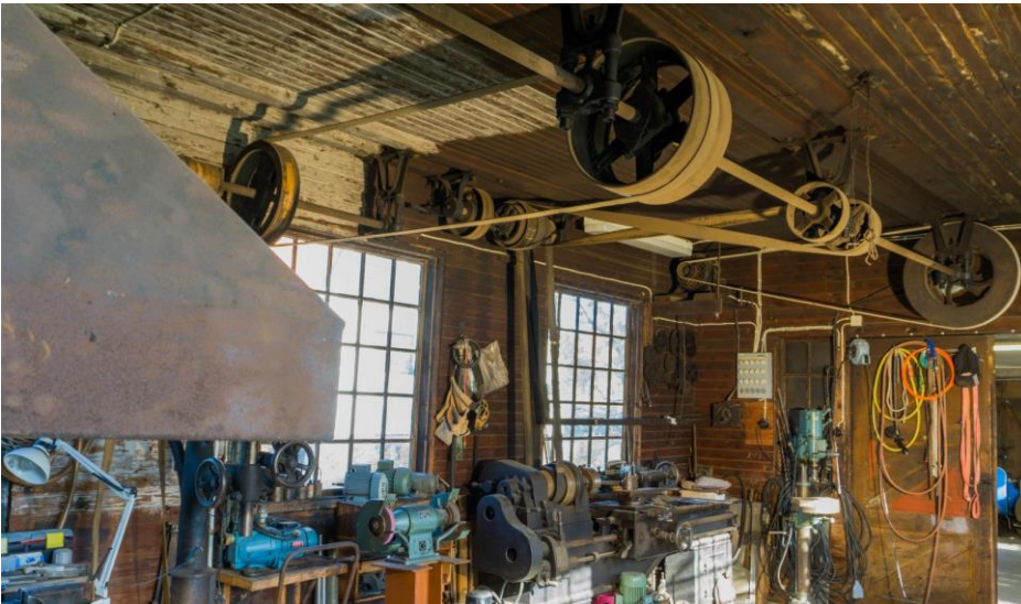
I taket på verkstaden fanns remdrift, som aktiverade bland annat svarv och pelarbormaskin. Foto: Kent Sjöström.
